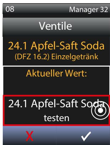
Das Ventil öffnet so lange wie die Option „Ventil öffnen“ gedrückt wird.
