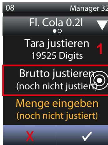
7. Beladen Sie jetzt die zu justierende Waage mit Flaschen bzw. befüllen Sie die leeren Flaschen bei der Justierung für den Offenausschank mit Wasser. Beachten Sie, dass während des Beladens der Digit-Wert stetig steigen muss, wodurch die korrekte Funktion der Waage kontrolliert werden kann. Warten Sie nun bis der Digit-Wert wieder konstant bleibt. Nur wenn der Wert beim Justieren nicht schwankt, kann ein genaues Abrechnen der Getränke gewährleistet werden.
