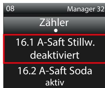
6. Nach der Deaktivierung des Zählers muss die Getränkeportion getestet werden und bei Bedarf die „Zähler-Justierung“ für die Zeitsteuerung des Ventils durchgeführt werden.
