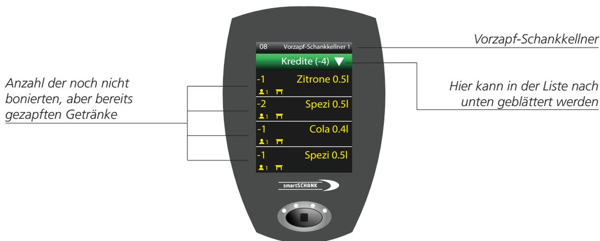
Um schnelleres Zapfen im Betrieb zu ermöglichen, kann durch erneutes anwählen einer Minusmenge das Produkt nochmals gezapft werden. Dies ermöglicht dem Schankkellner einen schnellen Zugriff auf bereits vorgezapfte Getränke. Eine erneute Auswahl über die Produkttaste ist nicht nötig.
