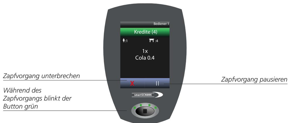
Sie können bei dieser Zapfmaske mit der Funktion „Pause“ entweder den Getränkeauschank pausieren, dies bedeutet das der Zapfvorgang nur kurz pausiert wird und die Zapfmaske in dieser Zeit offen bleibt, oder mit „X“ stoppen, wobei die geöffnete Maske geschlossen wird und Sie zur Übersicht aller offenen Kredite gelangen. Wird ein Zapfvorgang gestoppt, so wird dieser nicht aus dem System gelöscht, sondern lediglich unterbrochen.
