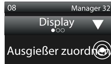
2. Folgen Sie der Anweisung und stecken Sie den Ausgießer, welchen Sie neu zuordnen möchten, in den Aktivatorring des Ringsystems.
