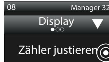
2. Bei Postmixgetränken können Sie im folgenden Untermenü wählen, ob Sie den Zähler für das Sodawasser, das Stillwasser oder den Sirup verändern möchten. Premixgetränke verfügen lediglich über einen Zähler. Wählen Sie den gewünschten Zähler, welcher neu justiert werden soll, wieder mit Hilfe eines Displaydrucks aus.
