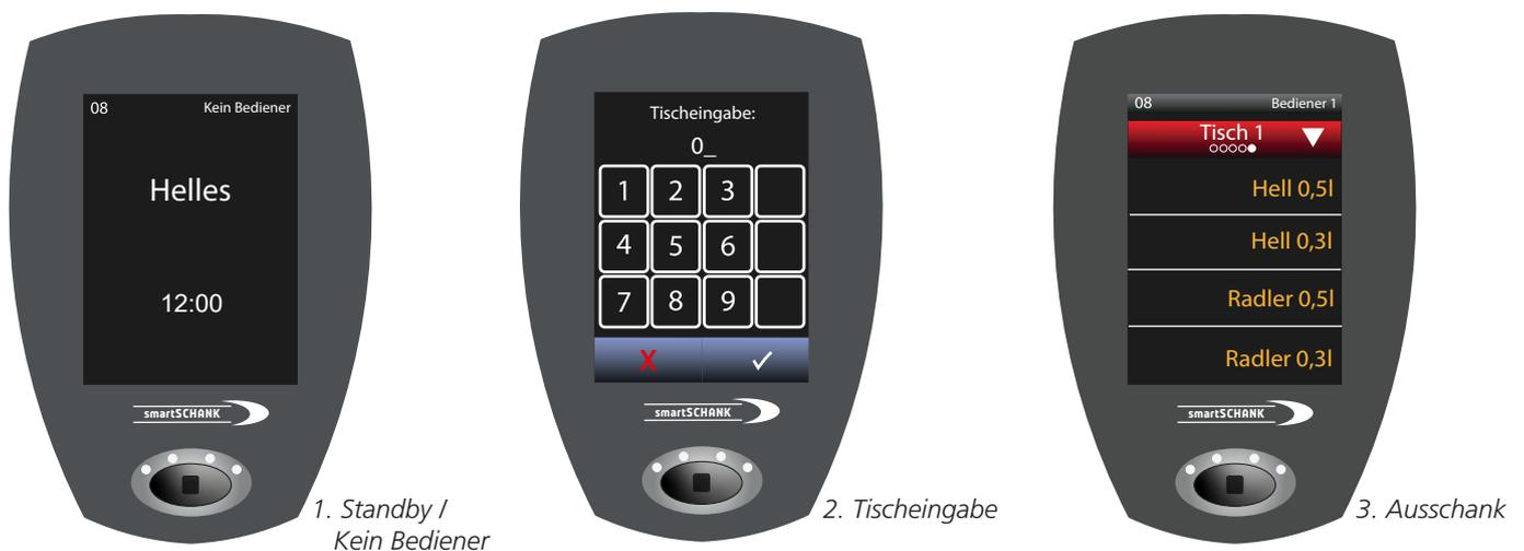
In der Regel ist es üblich, dass alle Getränke an den Zapfdisplays direkt boniert und automatisch von der Kasse abgeholt werden können. Die ausgeschenkten Getränke werden somit automatisch an der Schankanlage direkt auf den richtigen Tisch gebucht und an der Kasse abgerechnet.
